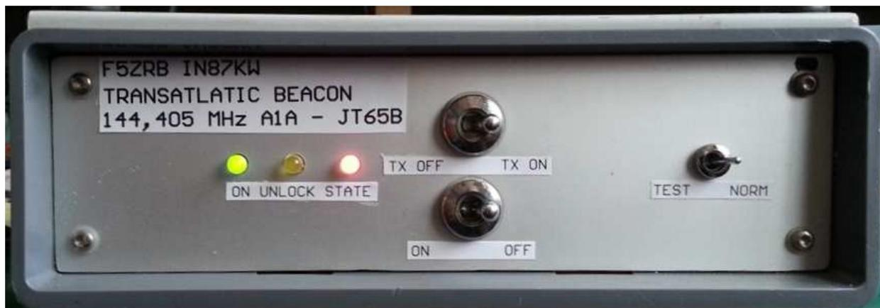
Ce projet est la reprise de ce qui a été conçu pour GB3VHF « New Generation » en 2005 par G4JNT et G4DDK, et particulièrement la partie DDS (hard et soft). Tous les circuits (DDS, verrouillage TC-VCXO, filtre à quartz et doubleur, driver PA) ont été redessinés et adaptés/complétés.
